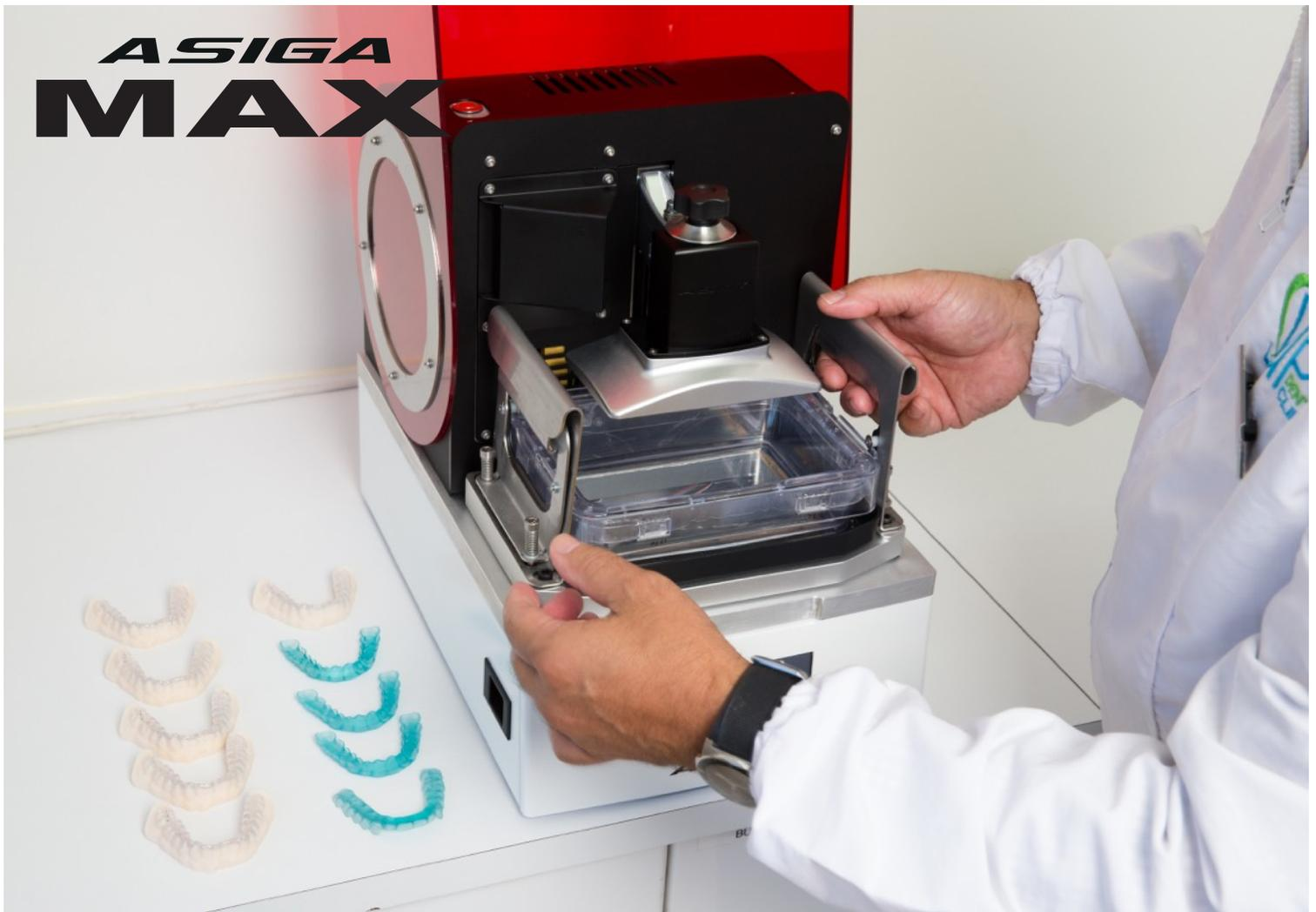
**Der ASIGA MAX ist der kompakte All-in-one 3D-Drucker.** Wie alle ASIGA-Printer ist er offen für Materialien verschiedener Hersteller und bietet Ihnen so ein Maximum an Flexibilität & Wirtschaftlichkeit! Drucken Sie Arbeitsmodelle, Bohrschablonen, Aufbiss-Schienen, Funktionslöffel und weitere Anwendungen der Zahntechnik.
